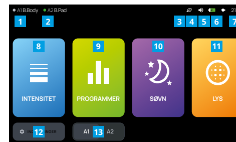
Hovedmenu til B.Box Evo med eksempelvisning af alle informations- og betjeningsselementer
